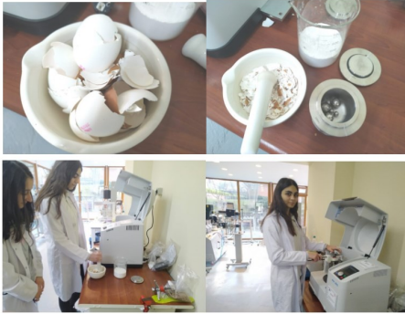
Şekil 2.2 Yumurta kabuklarının bilyalı öğütme süreci
